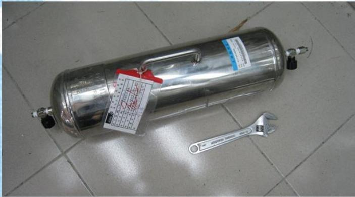
圖1：液化石油氣採樣鋼瓶實際大小（重約15公斤）與大板手之對照圖
